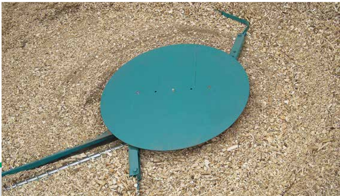
Vynášecí kanál s nakloněným řetězovým dopravníkem
