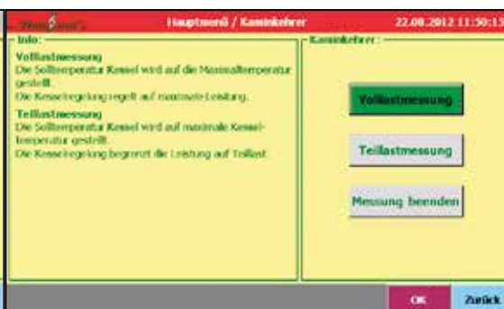
Komínový režim pro komfortní měření spalin
